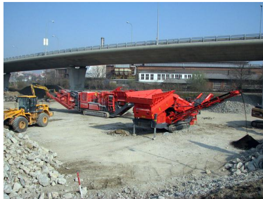
Mobilní odrazový drtáč s dvousměrným třídícím modulem Finlay L-1310RS
